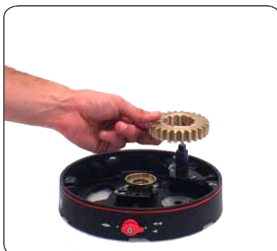
13. Remove the ratchet gear n°7
