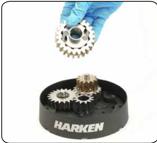
12. Remove the pawls carrier n°4
