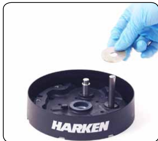
18. Remove the washer n°9
