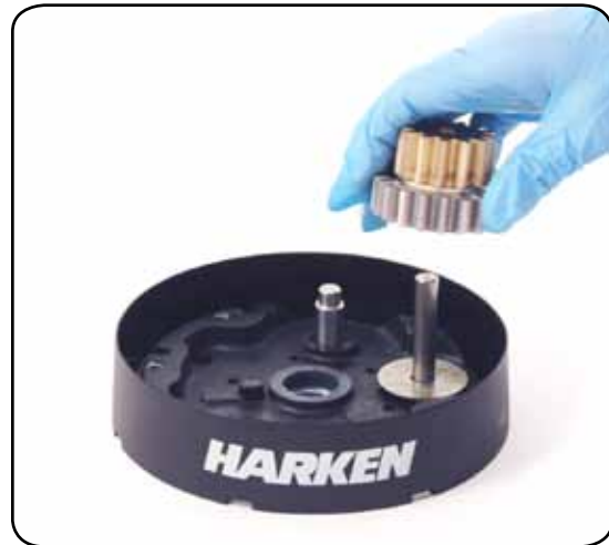
15. Remove the gear n°10
