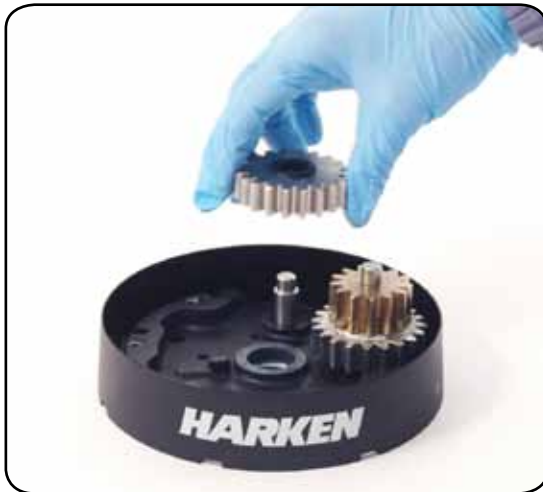
14. Remove the gear n°14
