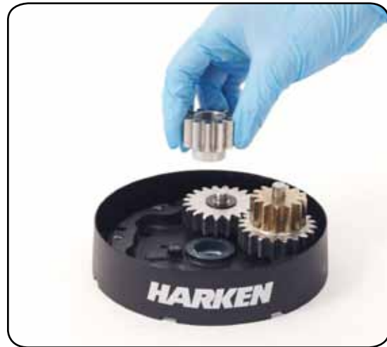
13. Remove the gear n°3
