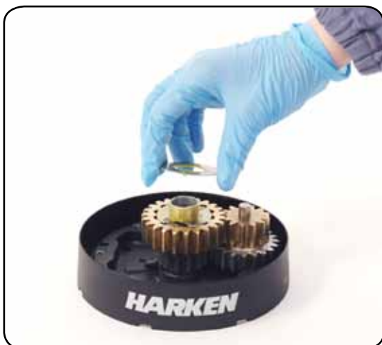
10. Remove the washer n° 12
