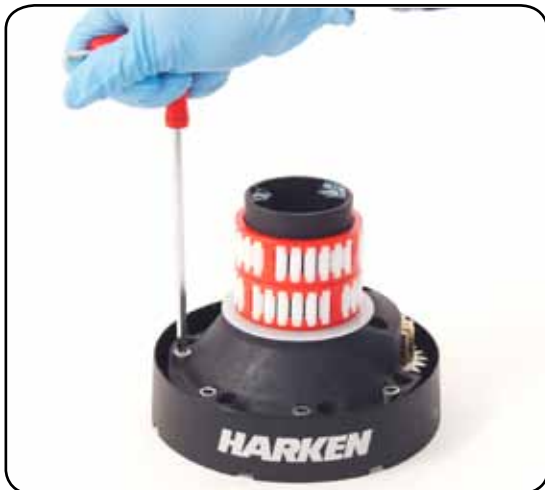
8. Unscrew the 6 hex screws n° 16 ( \approx 20\text{Nm}/177\text{ in-lb} )
