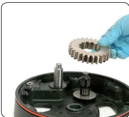
17. Remove the gear n°10
