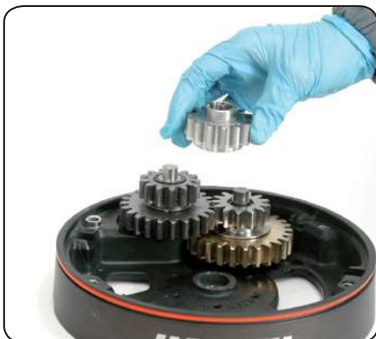
13. Remove the gear n°2
