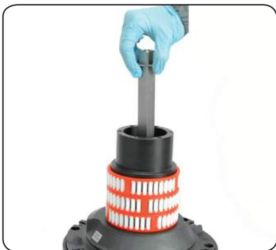
9. Slide out the central shaft n° 19
