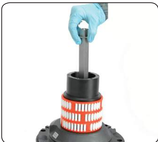
9. Slide out the central shaft n° 19
