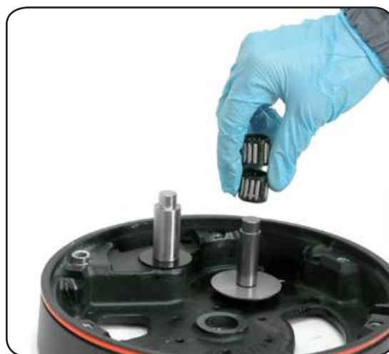
18. Remove roller bearings n°12
