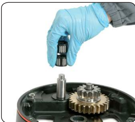
15. Remove roller bearings n°15
