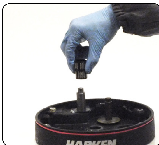
18. Remove roller bearings n°15
