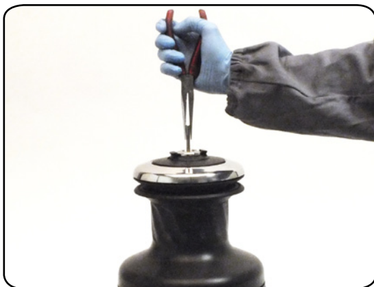
1. Pull out the disconnect rod n°39
