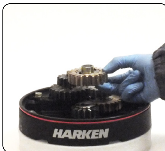
13. Remove the gear n°6, pawls carrier n°3 and the washer n°7
