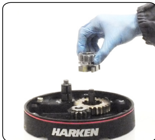
15. Remove the pawl carrier n°11
