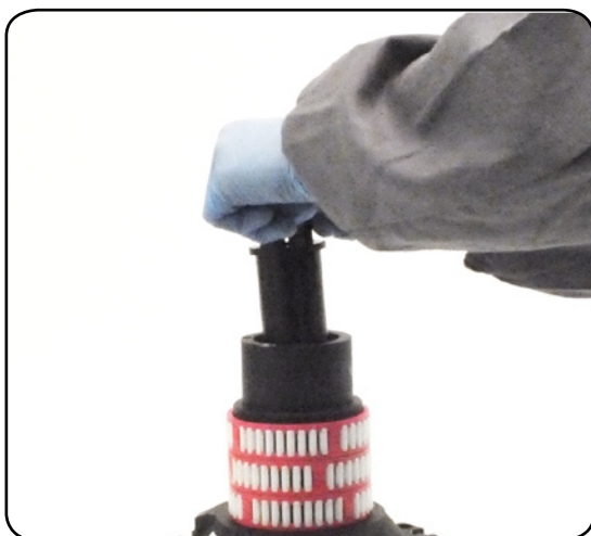
8. Slide out the assy clutch n°38
