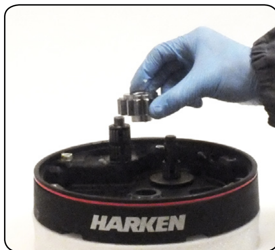
17. Remove the gear n°2
