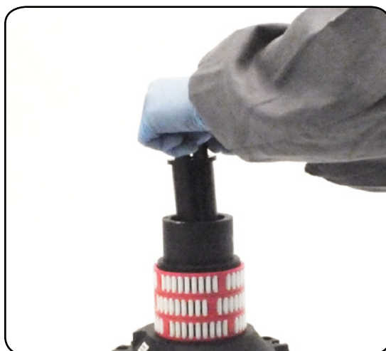
8. Slide out the assy clutch n°38
