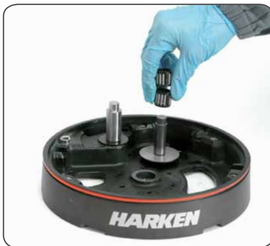
18. Remove roller bearings n°12
