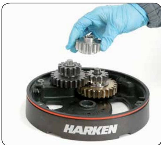
13. Remove the gear n°2
