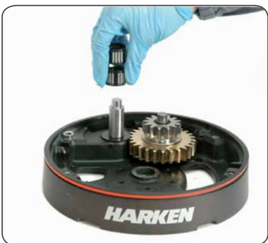
15. Remove roller bearings n°15
