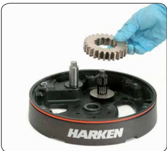
17. Remove the gear n°10
