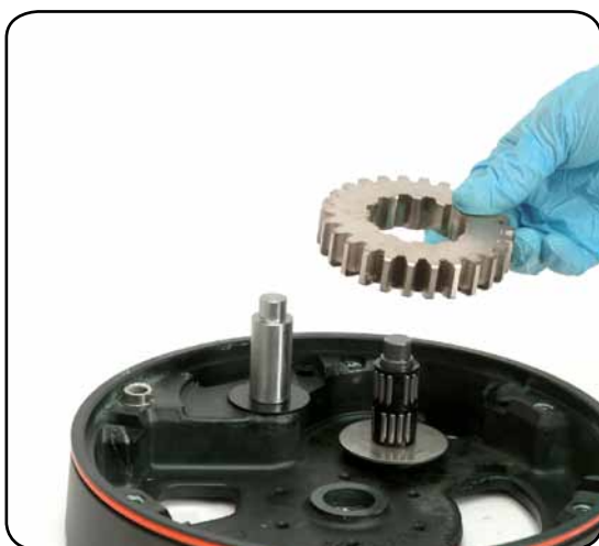
17. Remove the gear n°10
