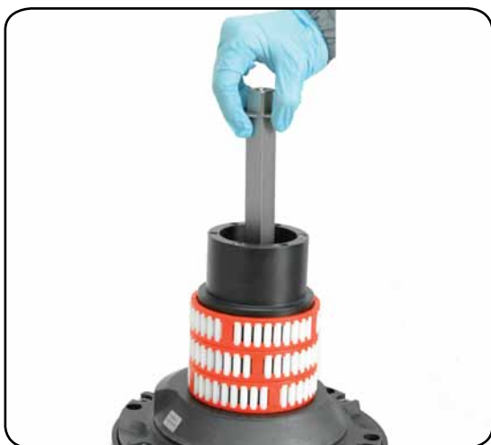
9. Slide out the central shaft n° 19
