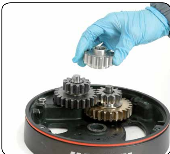
13. Remove the gear n°2
