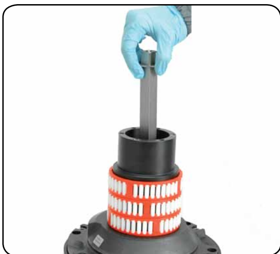
9. Slide out the central shaft n° 19
