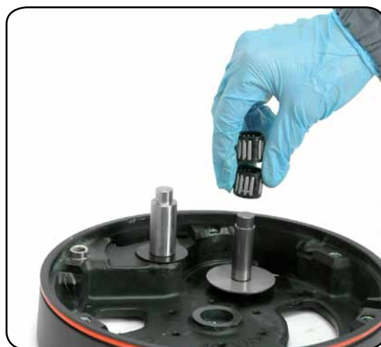
18. Remove roller bearings n°12
