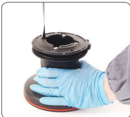
I. Unscrew the 4 screws n°39 ( \approx 4\text{Nm}/35\text{ in-lb} )
