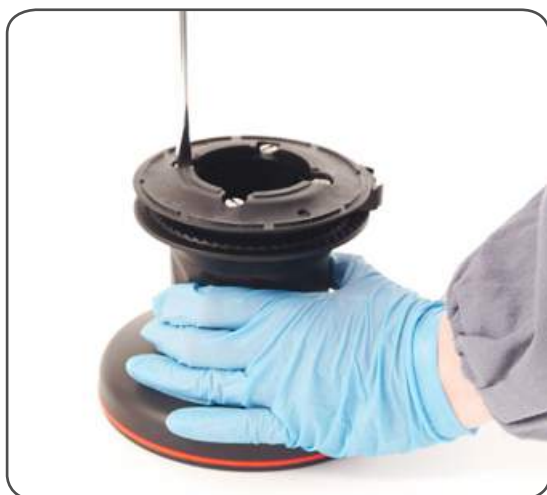
I. Unscrew the 4 screws n°18 ( \approx 4\text{Nm}/35\text{ in-lb} )
