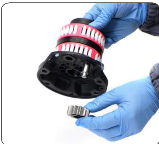
9. Slide out the gear n°10
