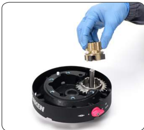
13. Remove the pinion n°7
