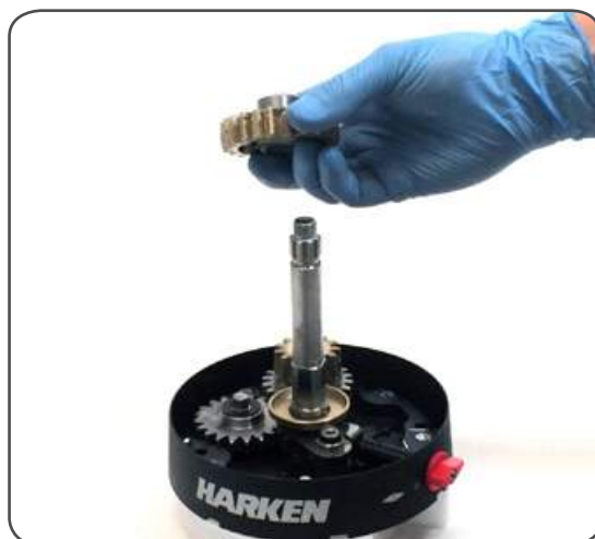
11. Slide out the gear n°32
