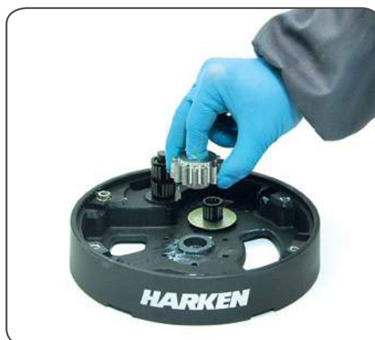
17. Remove the gear n°2
