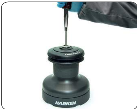
1. Pull out the disconnect rod n°38
