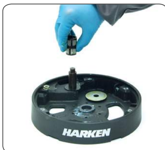
18. Remove roller bearings n°15
