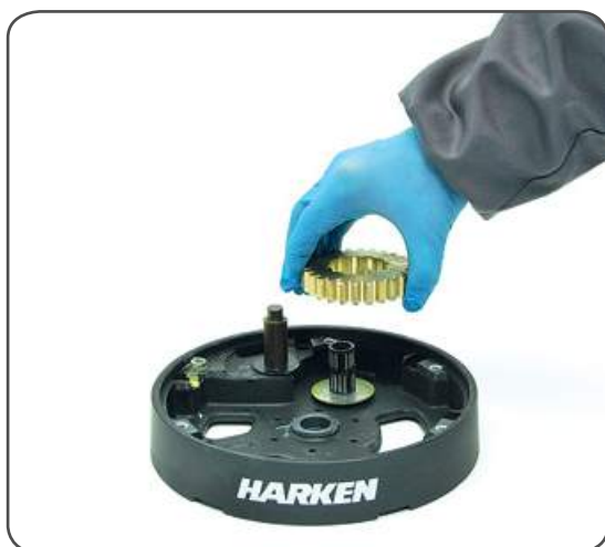
17. Remove the gear n°10
