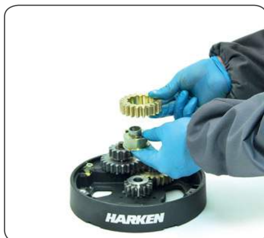
12. Remove the gear n° 6, pawls n° 4 and the washer n° 7
