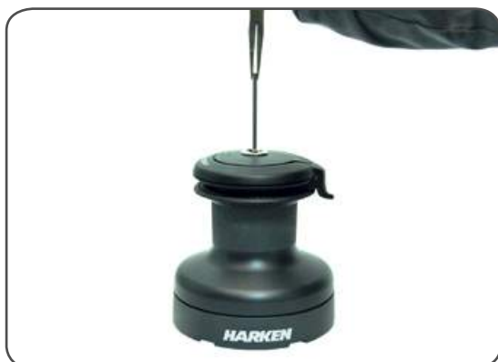
1. Pull out the disconnect rod n°30
