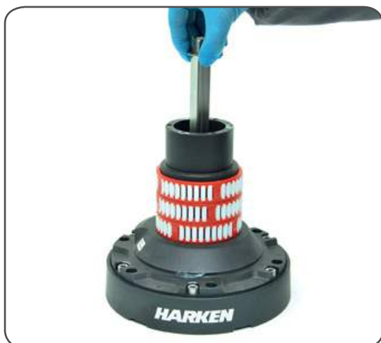
9. Slide out the central shaft n° 19
