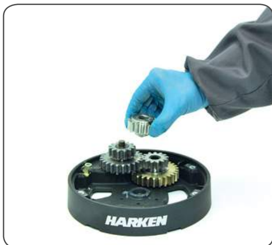
13. Remove the gear n°2.
