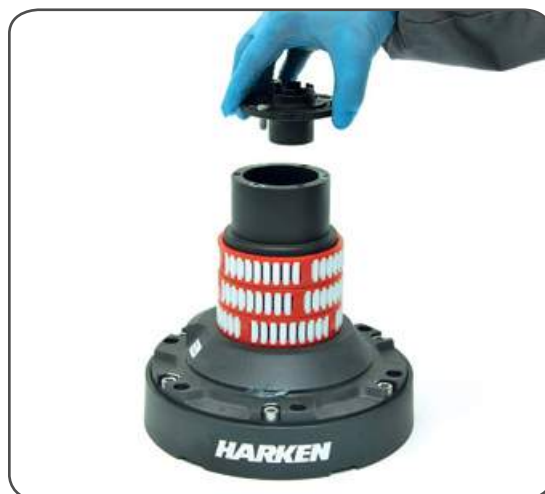
8. Remove the stripper arm support n° 21
