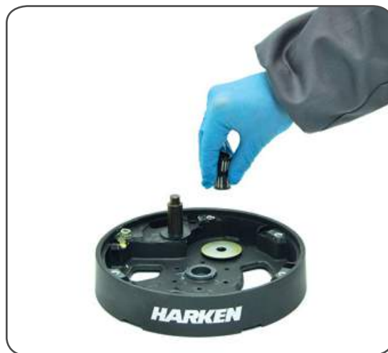
18. Remove roller bearings n°12.
