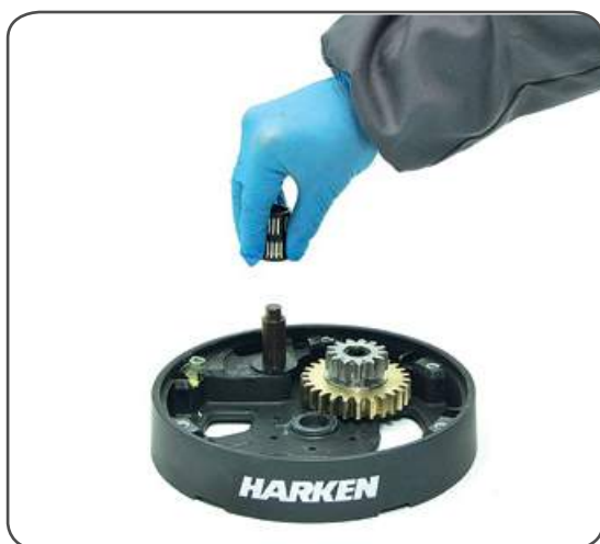
15. Remove roller bearings n°15
