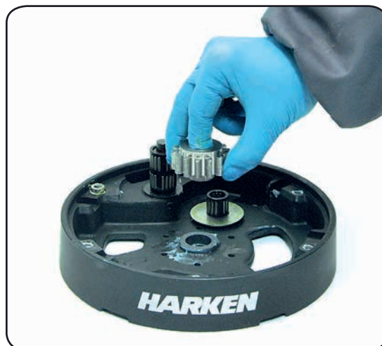
16. Remove the gear n°2
