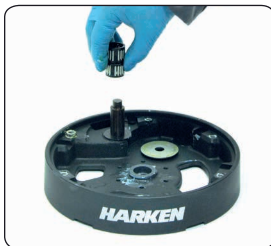
18. Remove roller bearings n°15
