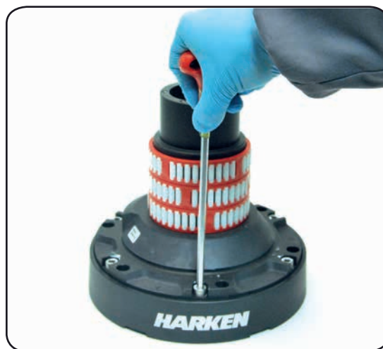
9. Unscrew the 6 hex screws n°17 ( \approx 20\text{Nm}/177\text{ in-lb} )
