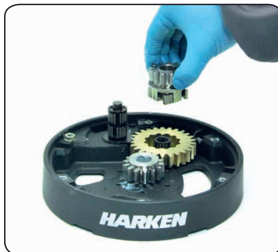
14. Remove the pawl carrier n°11
