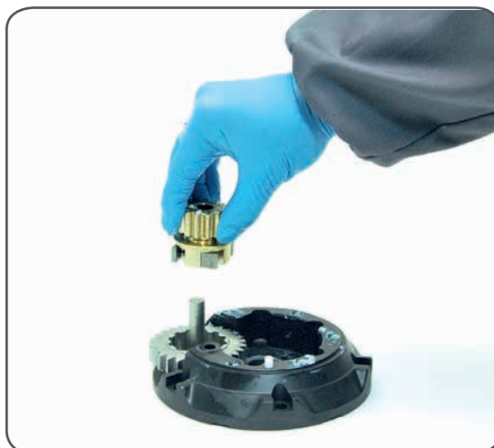
14. Remove the pinion n°10.
