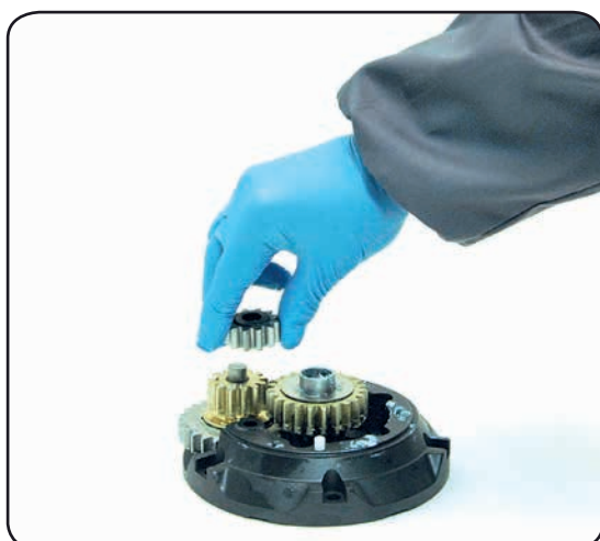
10. Remove the gear n°14
