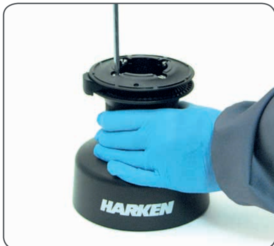
I. Unscrew the 4 screws n°23 ( \approx 4\text{Nm}/35\text{ in-lb} )
