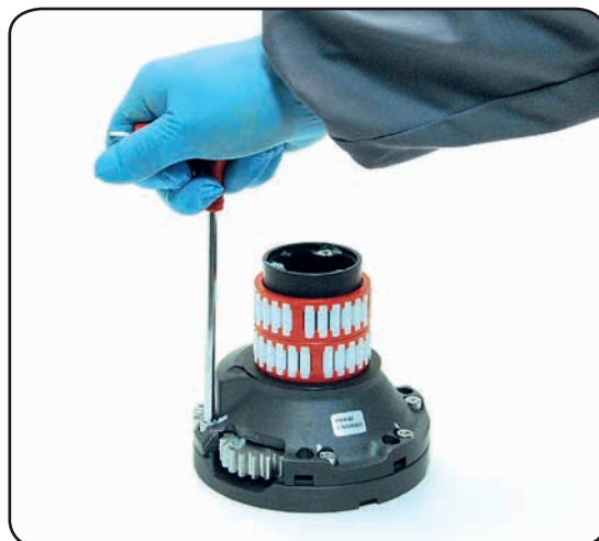
9. Unscrew the 6 hex screws n° 15 ( \approx 8\text{Nm}/71\text{ in-lb} )
