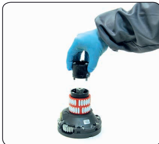
7. Remove the stripper arm support n° 20
