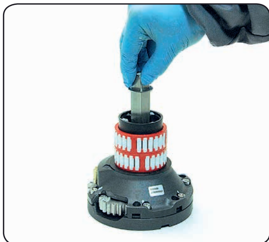
8. Slide out the central shaft n° 18
