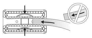
For horizontal curved track only Pour rail cintré horizontal uniquement nur für horizontale gebogene Schiene Solo per rotaie curvate orrizontale Solamente para el rail curvado horizontal
