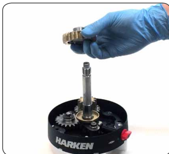
11. Slide out the gear n°32
