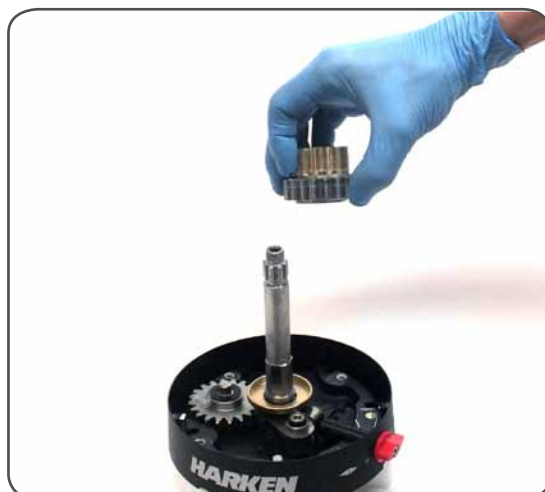
14. Remove the gear n°7 and the pinion n°8
