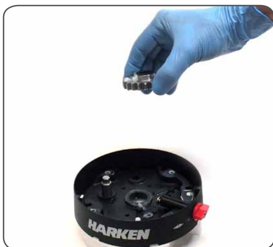
19. Remove the gear n°10
