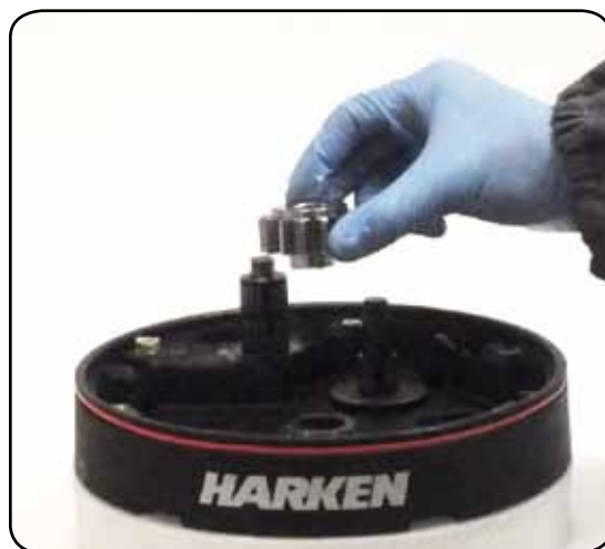
17. Remove the gear n°2
