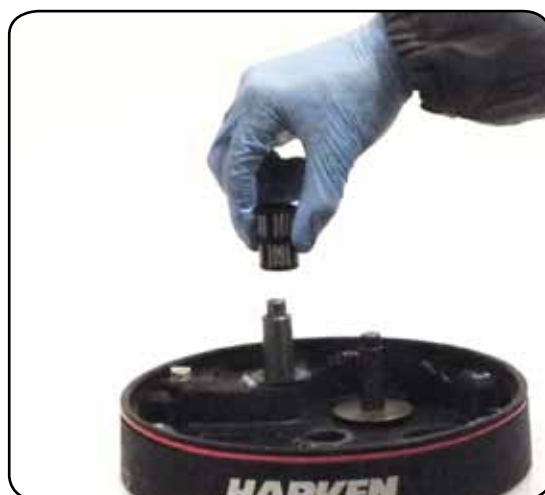
18. Remove roller bearings n°15
