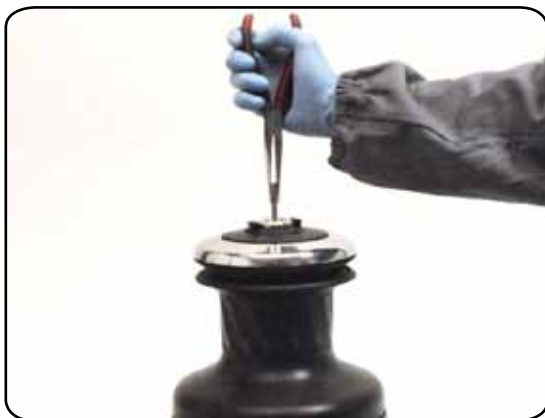
1. Pull out the disconnect rod n°39
