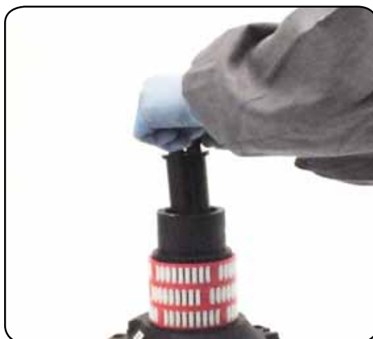
8. Slide out the assy clutch n°38
