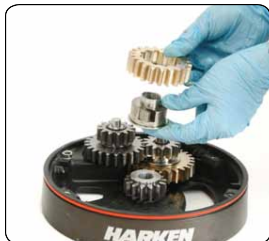
12. Remove the gear n°6, pawls n°3 and the washer n°7
