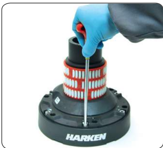
10. Unscrew the 6 hex screws n°17 ( \approx 20\text{Nm}/177\text{ in-lb} )
