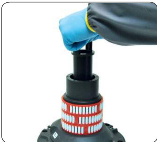
8. Slide out the assy clutch n°36
