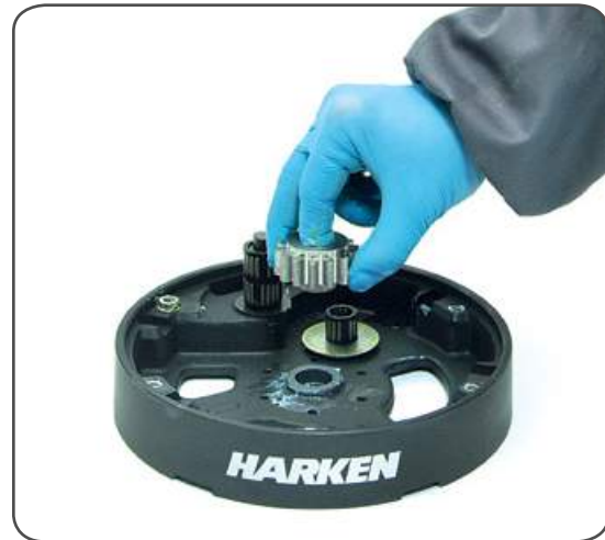
17. Remove the gear n°2
