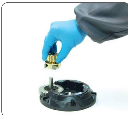
15. Remove the pinion n°10.
