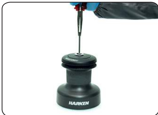
1. Pull out the disconnect rod n°30
