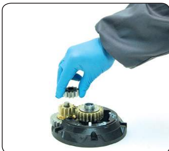
11. Remove the gear n°15
