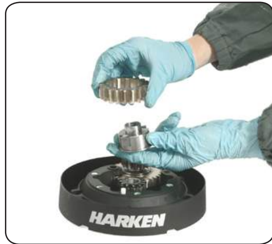
13. Remove the pawls carrier n°7
