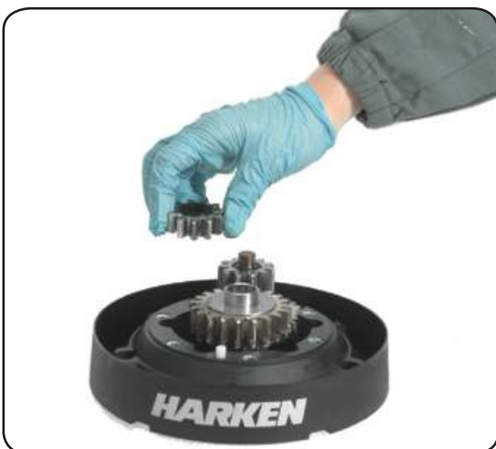
10. Remove the gear n°16
