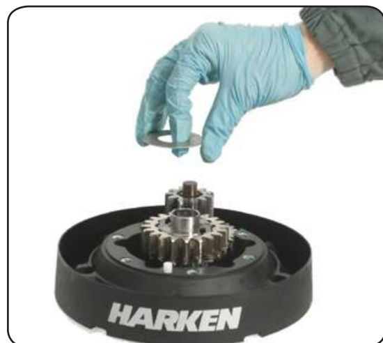
11. Remove the washer n°14
