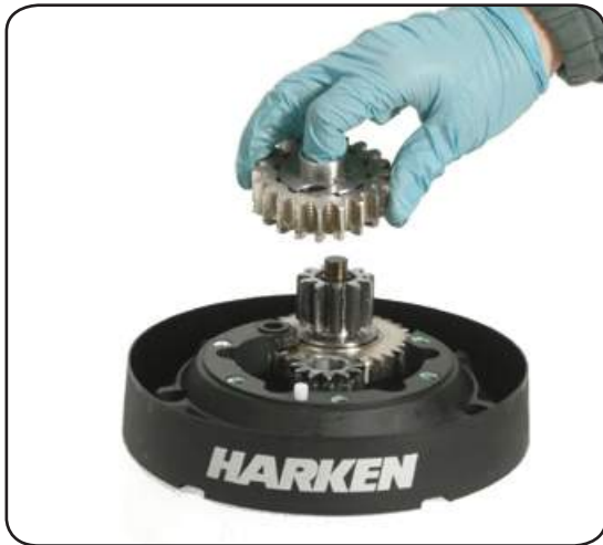
12. Remove the gear n°10
