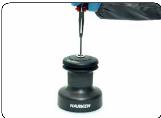
1. Pull out the disconnect rod n°30
