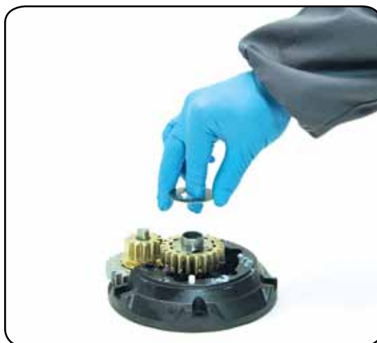
12. Remove the washer n°12
