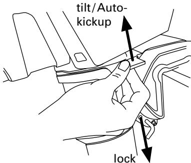
En position «Tilt/Auto kick-up» (levier en haut), le levier de verrouillage du mécanisme basculant permet de basculer le moteur vers le haut lorsqu'il touche le fond. Dans cette position, il n'est pas possible de faire marche arrière à plein gaz ni de ralentir.
