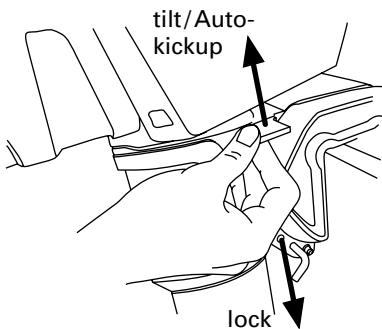
Met de kip-arrêteerhefboom in de „Tilt/Auto kick-up“ positie (hefboom boven) wordt de motor bij contact met de bodem omhoog gekanteld. In die positie kan niet met vol gas achteruit worden gevaren en gestopt.
