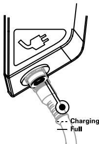
De laadbus van de accu is met een stekker gekenmerkt. Om te laden wordt de voedingseenheid met stopcontact en laadbus verbonden.
