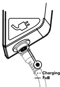
La prise de recharge de la batterie est indiquée par une prise. Pour effectuer le rechargement, le chargeur secteur se branche avec la prise secteur et la prise de recharge.
