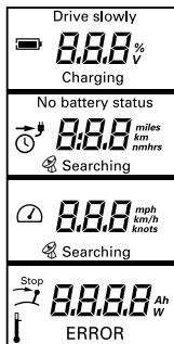
Le module GPS intégré à la batterie recherche les signaux de satellites afin de déterminer la vitesse. Tant qu'aucun signal GPS n'est reçu, il s'affiche dans le deuxième champ « l'autonomie restante à la vitesse actuelle » (indication de la durée) ainsi que le symbole d'une horloge. Si la durée restante est supérieure à 10 heures, l'autonomie
