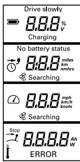
De GPS-module die in het accupack is geïntegreerd, zoekt satellietsignalen om de snelheid te bepalen. Zo lang er geen GPS signaal wordt ontvangen, geeft de indicatie in het tweede veld altijd de „Restende looptijd bij actuele snelheid“ (tijdindicatie) aan. Ook een kloksymbool wordt weergegeven. Als de resterende looptijd groter is dan 10 uur, wordt de resterende looptijd in volledige uren aangegeven.
